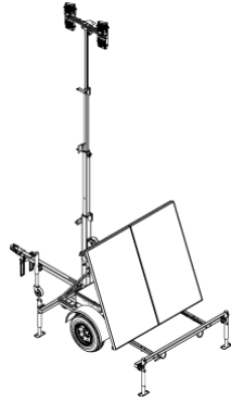
600-watt solar array
